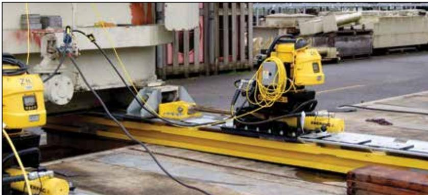
▼ Sapata de Esquidagem com levantamento hidráulico HSKJ-1250
